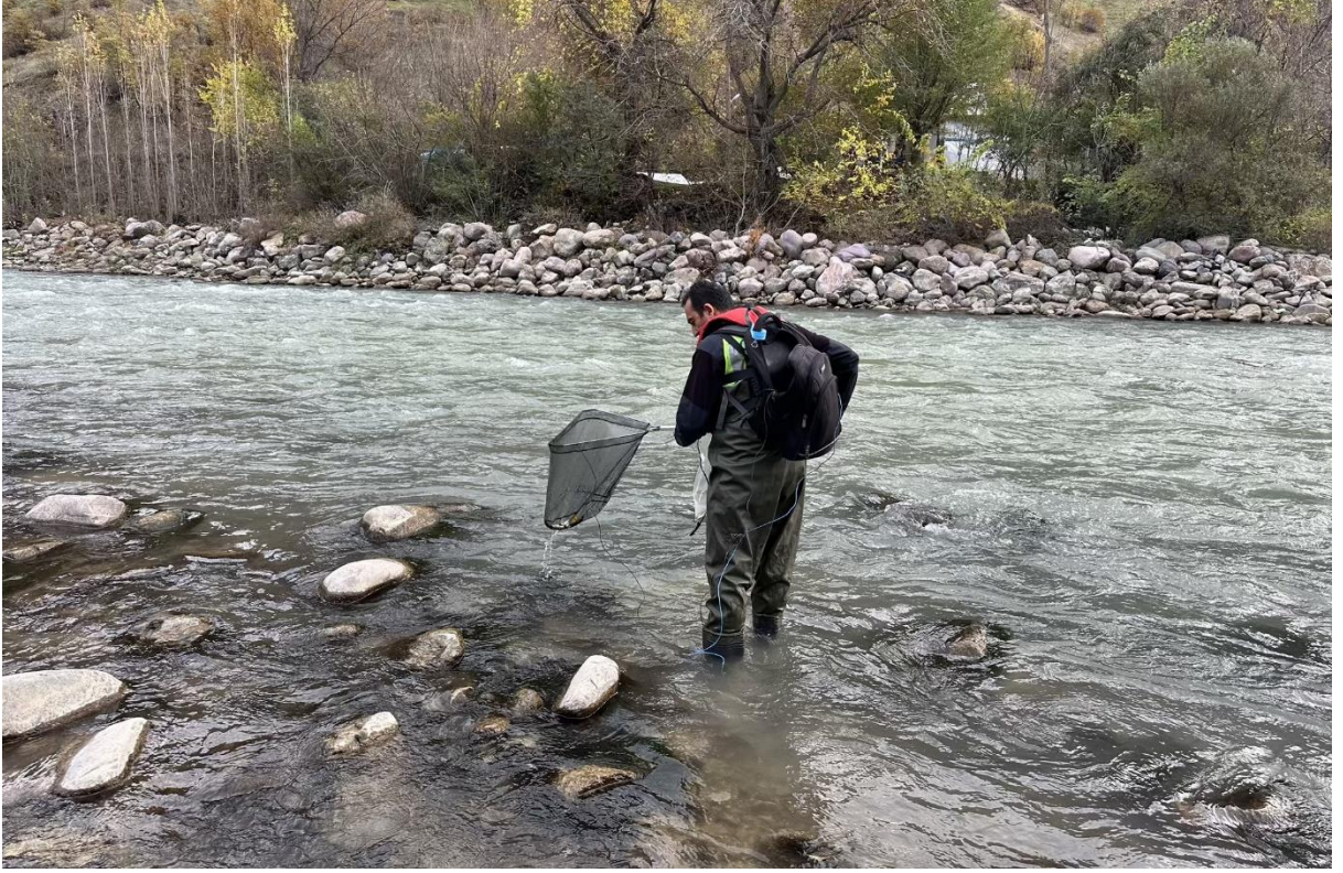
Şekil 96. Elektro Şoker kullanılarak yapılan örnekleme çalışması (1. İstasyon)
