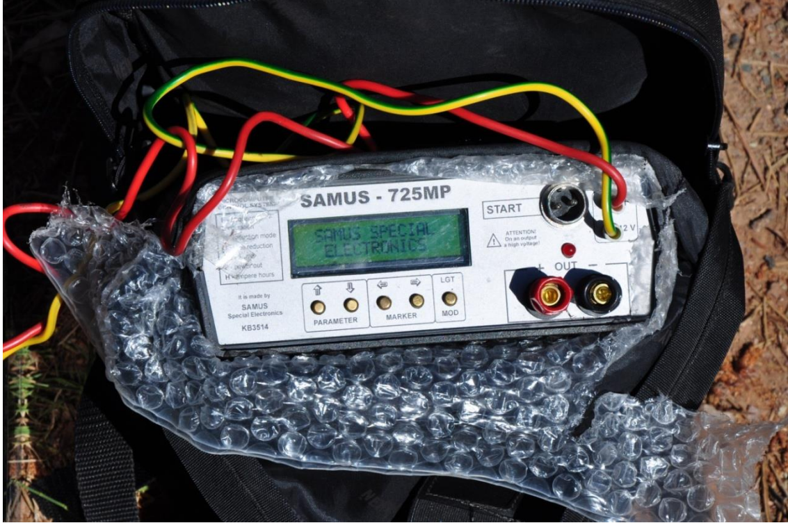
Şekil 94. Çalışmalarda kullanılan SAMUS 725MP Model Elektro Şoker
